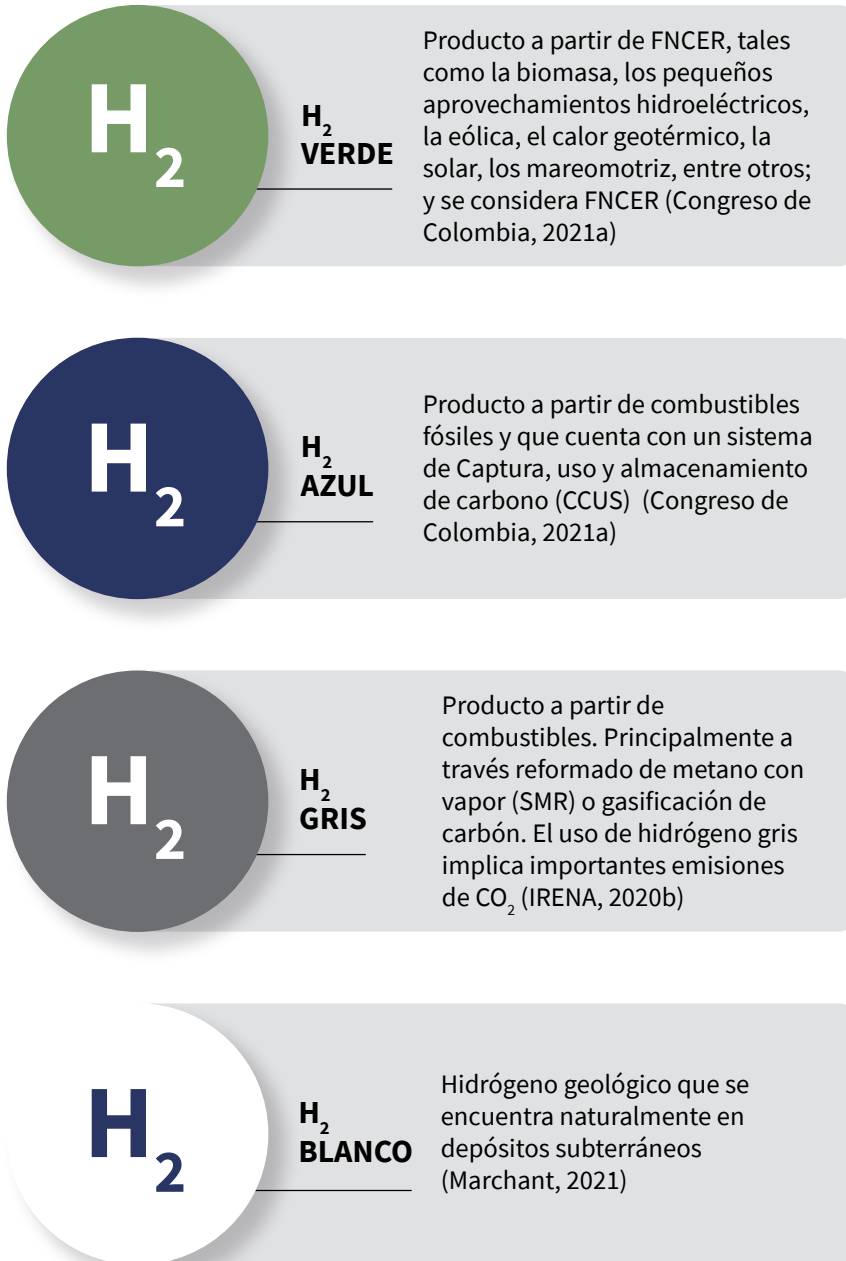
FIGURA 1. CLASIFICACIÓN DEL HIDRÓGENO SEGÚN FUENTE DE PRODUCCIÓN
