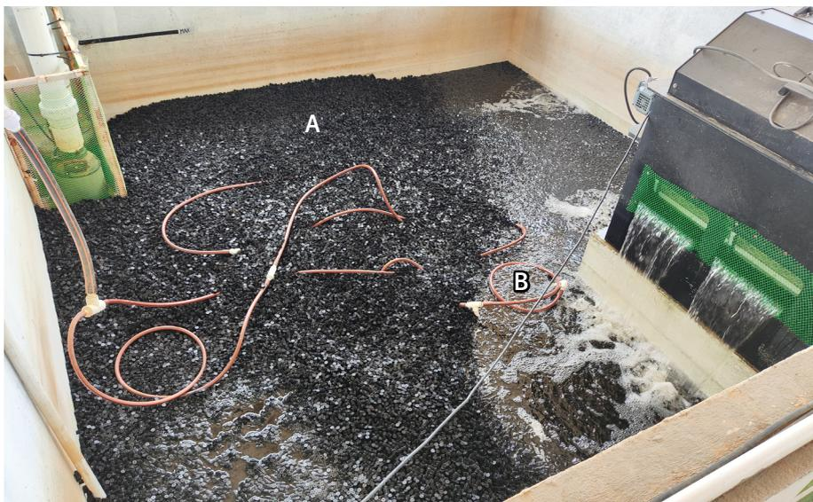
Nota: el agua pasada por el filtro tambor cae al biofiltro en donde se lleva a cabo la nitrificación gracias a los bioelementos (A) y el oxígeno proporcionado por las mangueras difusoras (B).
