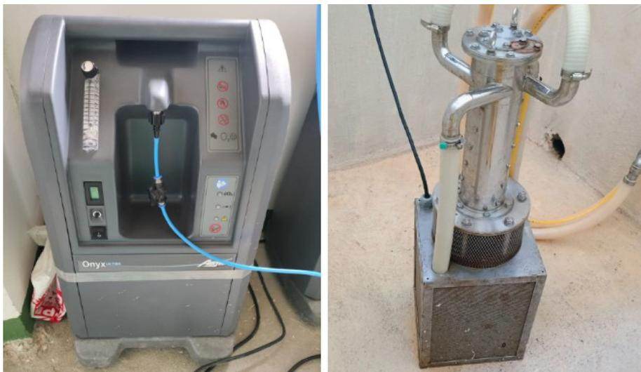
En la izquierda se aprecia el generador de oxígeno puro y en la derecha el generador de nanoburbujas a partir del oxígeno proporcionado por el generador.
